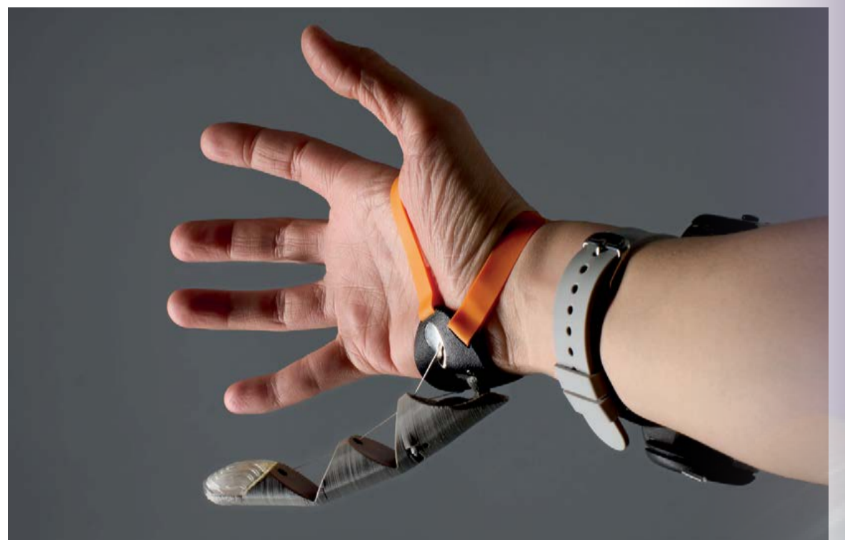
EL PULGAR ROBÓTICO SE SUJETA SOBRE LA PALMA y se controla con sensores de presión situados bajo cada uno de los dedos gordos de los pies.
