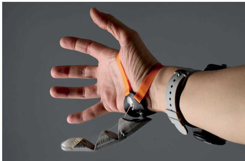
EL PULGAR ROBÓTICO SE SUJETA SOBRE LA PALMA y se controla con sensores de presión situados bajo cada uno de los dedos gordos de los pies.
